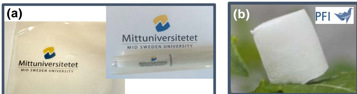
Figur 1. Exempel på olika cellulosa-kompositer med barrär- och isolerande egenskaper som framställts av Mittuniversitetet och PFI. (a) Cellulosa-kitosanfilmer med låg gaspermeabilitet. (b) Nanocellulosa aerogel med mycket goda isolerande egenskaper.
